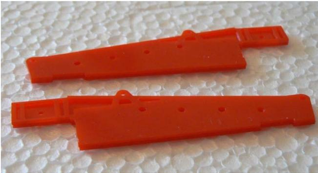
Teile 201 werden auf 202 geklebt. Hier ist zu beachten, dass die andere Seite spiegelverkehrt gebaut werden muss.
