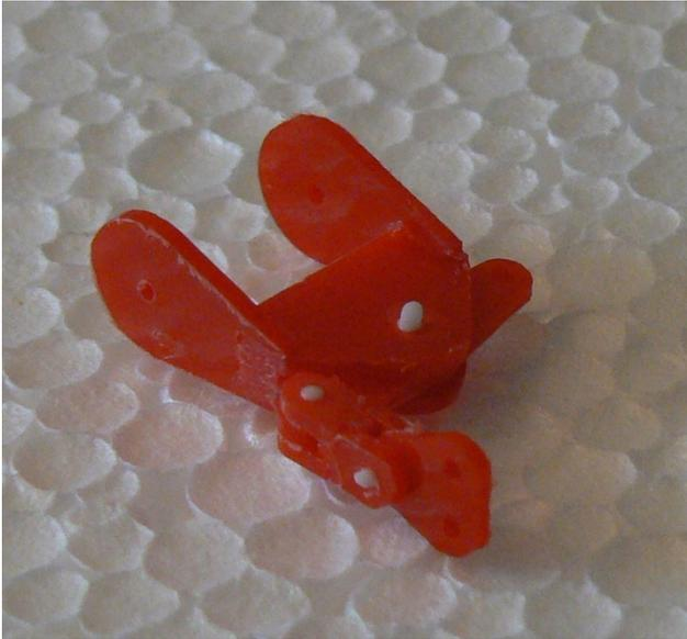
Jetzt wird ohne zu kleben Teil 304 an 303 mit einem Rundstab mit 1,0mm Durchmesser montiert. Dann werden 4x305 aneinander geklebt. (siehe Bild) Dreieck 306 wird auch mit einem Rundstab von 1,0mm
