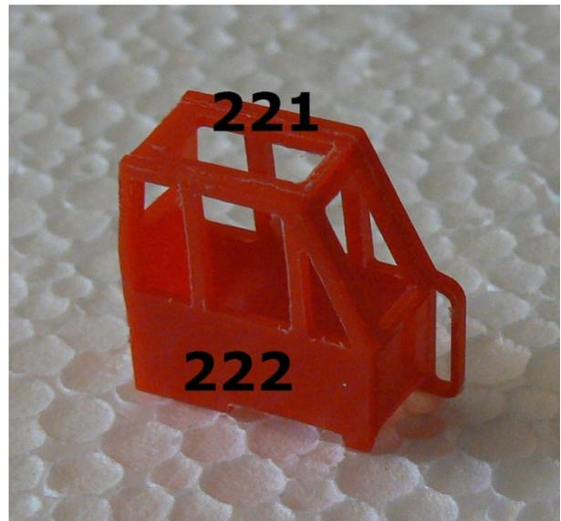
An die Obenseite wird Dach 221 geklebt. Seite 222 macht die Kabine komplett. Vorher sollte geprüft werden, dass, die Inneneinrichtung noch hinein passt.
