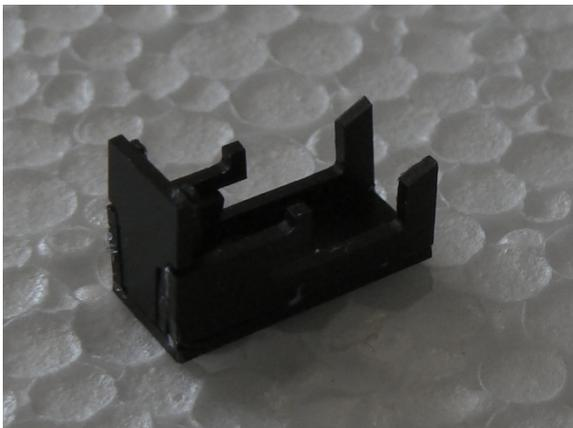
Das gesamte Teil wird zwischen den Teilen 101 montiert. Sitze 104 wird auf 101 geklebt. Die Rückseite 105 wird auf 104 geklebt.
