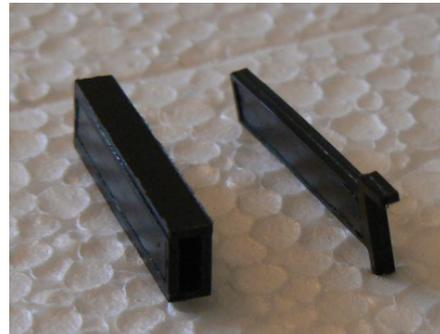
Klebe 2x Nr. 42 rückseitig aneinander, um ein Teil zu erhalten. Dieser Schritt ist für die drei anderen Stützen ebenfalls erforderlich. Aus Nr. 40 und 41 wird ein Kasten mit genügend Raum für Nr. 42 gebildet. Die gefrästen Flächen der Teile mit der Nr. 40 sollen nach Aussen gerichtet sein.
